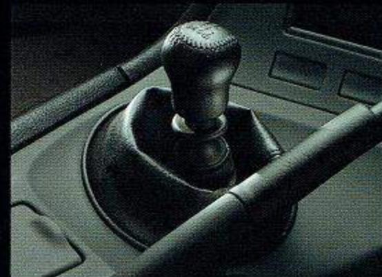
M/T用本革巻きシフトレバーノブ [RZ,SZ-RのM/T車に標準] 短く垂直に立ち、機敏な操作感が得られるノブ形状の本革巻き。
