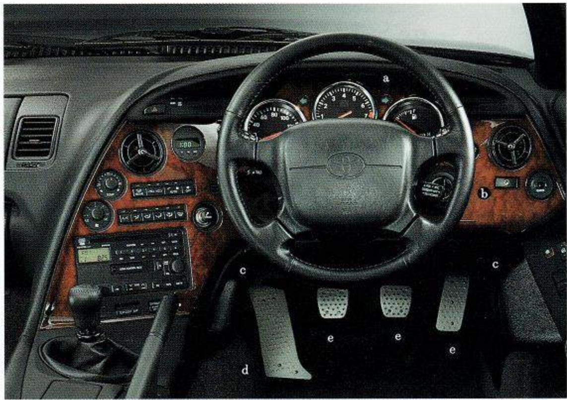
a メーターリングセット b ウッド調パネル c ニーサポートセット d アルミフットレスト e アルミペダルセット
