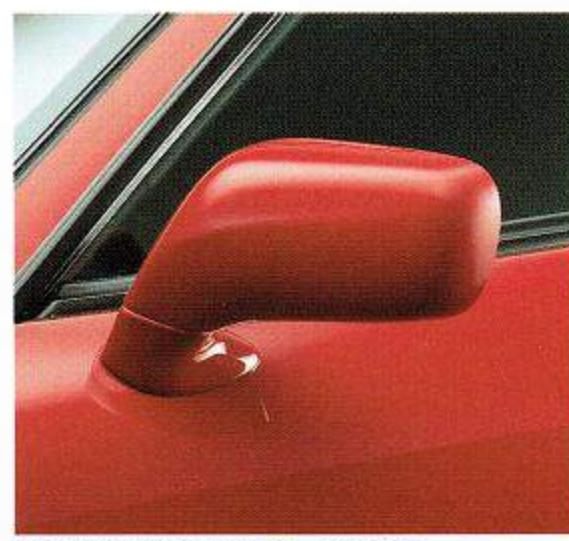
④ 電動格納式リモコンカラードアミラー
