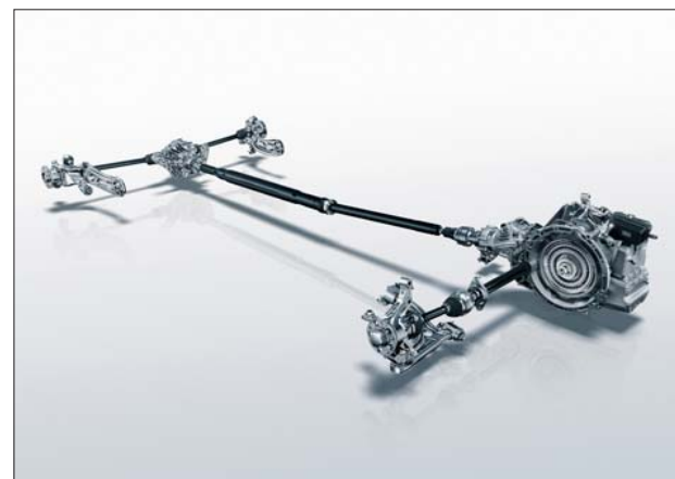
可変トルク配分型四輪駆動4MATIC
