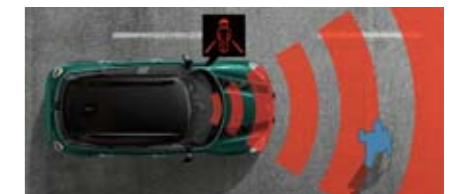
ドライビング・アシスト (前車接近警告機能、衝突回避・被害軽減ブレーキ)
