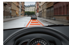
ドライビング・アシスト (前車接近警告機能、 衝突回避・被害軽減 ブレーキ)
