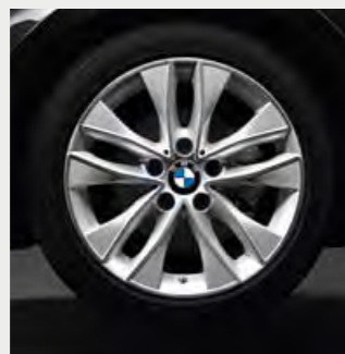
* 17インチ V スポーク・スタイリング 412 アロイ・ホイール : 7.5J×17ホイール、225/45R17 タイヤ (ランフラット・タイヤ)
