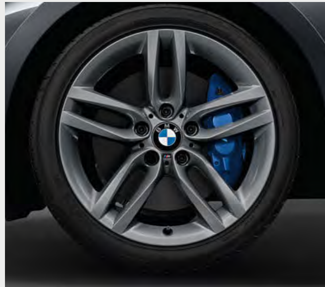
* 18インチ M ライト・アロイ・ホイール・ダブルスポーク・スタイリング 461M (フェリックス・グレー) : (フロント) 7.5J×18ホイール、225/40R18 タイヤ、(リア) 8J×18ホイール、245/35R18 タイヤ (ランフラット・タイヤ) ※ スノー・チェーンは装着できません。
