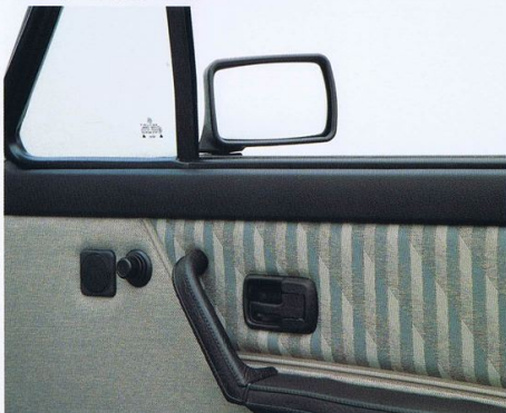
室内より調整可能なドアミラー(手動)
