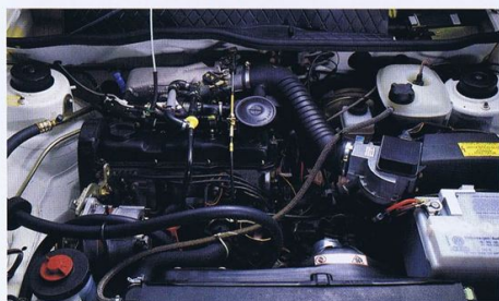
直列4気筒水冷フロントエンジン
