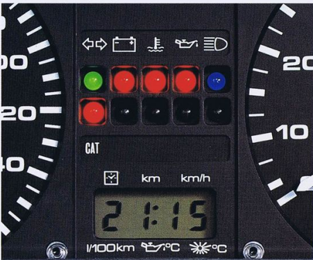
時刻をはじめ7つの情報をデジタル表示するマルチファンクションインジケーター。
