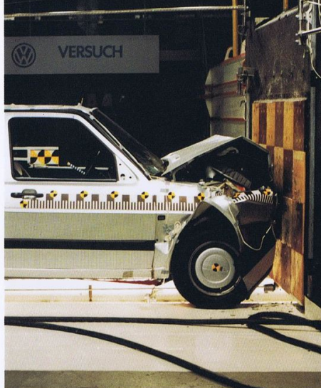
時速50kmで固定壁に衝突させ、ボディの衝撃吸収、変形、人が乗るスペースへの影響を調べるクラッシュテスト。
