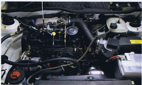
直列4気筒水冷フロントエンジン
