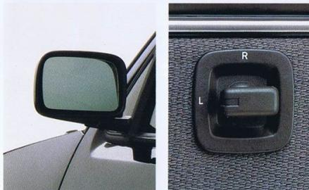
熱線入り電動リモートコントロールアミラー&コントロールスイッチ
