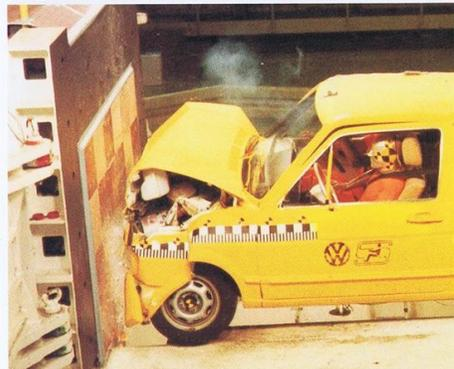
人体への影響を正確に測定するために、実際の事故と同様の状況を設定して行われる衝撃テスト。
