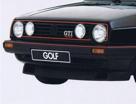
ブレーキ冷却エアタクト付フロントスポイラー（ヘッドライトの内側2灯は点灯いたしません）
