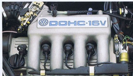
後部のレスポンスを得るDOHC16バルブエンジン。
