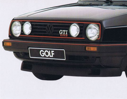
ブレーキ冷却エアダクト付フロントスポイラー(ヘッドライトの内側2灯は点灯いたしません)
