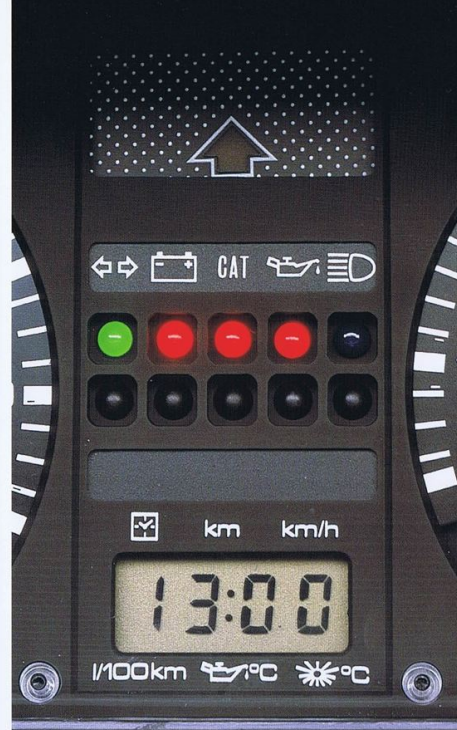
7つの情報をデジタル表示するマルチファンクション インジケーター
