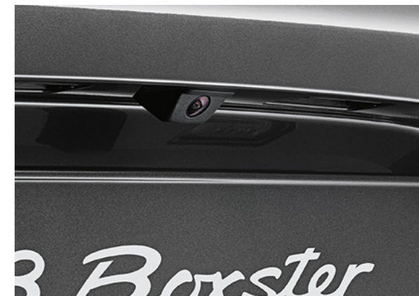
リアビューカメラ付パークアシスト(フロントおよびリア)
