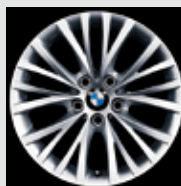
2S5 マルチスポーク・スタイリング293 アロイ・ホイール (フロント)8J×18ホイール+225/40R18タイヤ (リヤ)8.5J×18ホイール+255/35R18タイヤ [ランフラット・タイヤ]
