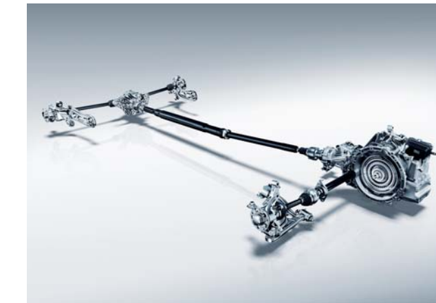
可変トルク配分型四輪駆動4MATIC
