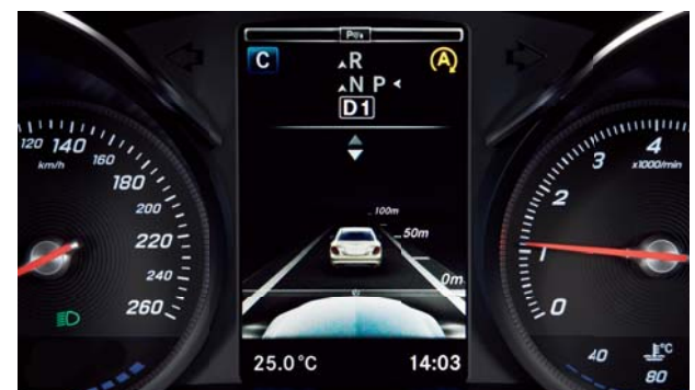
アクティブディスタンスアシスト・ディストロニック&アクティブステアリングアシストのディスプレイ表示
