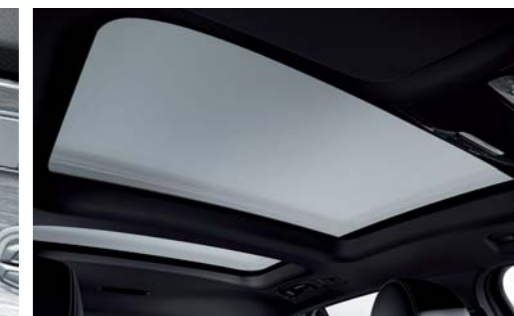
パノラミックスライディングルーフ(挟み込み防止機能付)*5
