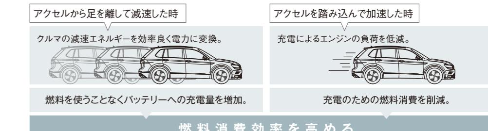
車両の運動エネルギーを効率的に利用し、燃費の向上につなげるシステム。走行中、ドライバーがアクセルペダルから足を離したり、ブレーキを掛けた際に発生する減速エネルギーをバッテリーに充電。逆に加速時は充電のためのエンジンの負荷を低減し、無駄な燃料消費を抑えます。
