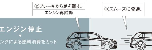
アイドリングストップ技術により、無駄な燃料の消費を抑えるシステム。信号の多い街中や渋滞時にクルマを停止させた際、ブレーキペダルを踏みつづけると自動的にエンジンが停止。発進の際はブレーキペダルから足を離せばスムーズに再始動します。エンジンの自動停止はACC(アダブティブクルーズコントロール)やオートホールド、エレクトロニックバーキングブレーキの作動中でも行なえます。さらにアクセルオフやブレーキ操作などによる、停車に向けた制御の実行中にも自動停止が可能です。
