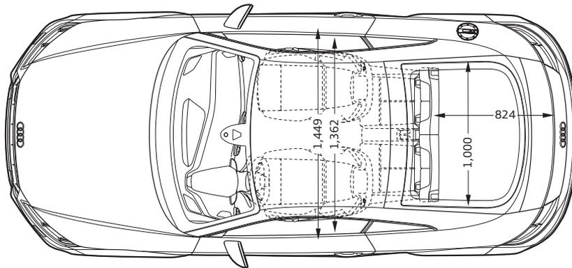
\*1 S lineパッケージ装着時は+10mm \*2 S lineパッケージおよびマグネティックライド装着時は -10mm ※単位 : mm イラストは欧州仕様車となります。車両は日本仕様とは異なります。
