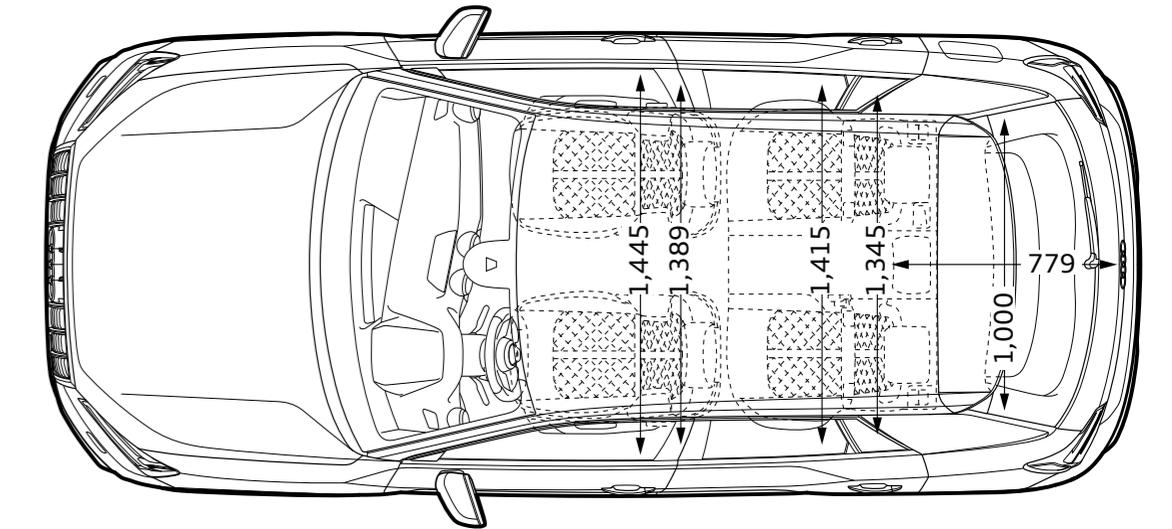
\*1 S line装着車の場合+5mmとなります。 \*2 S line装着車の場合-10mmとなります。 \*3 MMIナビゲーションシステム装着車の場合+30mmとなります。 ※単位：mm イラストは欧州仕様車となります。車両は日本仕様とは異なります。
