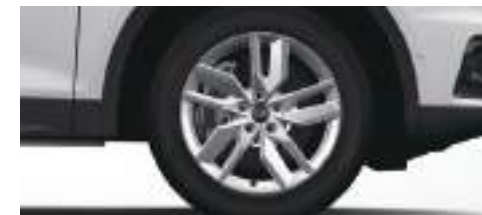
アルミホイール 5アーム タービンデザイン 8J×18 +235/60 R18タイヤ [Audi Q5 2.0 TFSI quattroに標準装備]
