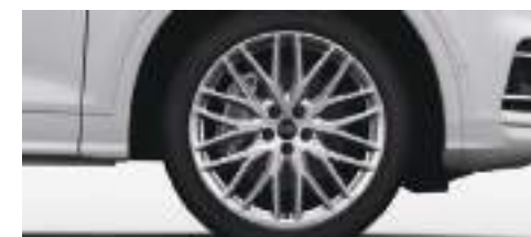
アルミホイール 10Yスポーク 8J×20 +255/45 R20タイヤ [Audi Q5 2.0 TFSI quattroにデビューパッケージとしてセットオプション]
