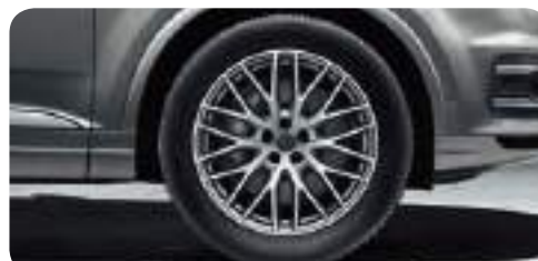
アルミホイール 10Yスポークデザイン 9J×20 (Audi Sport) [Audi Q7にオプション]
