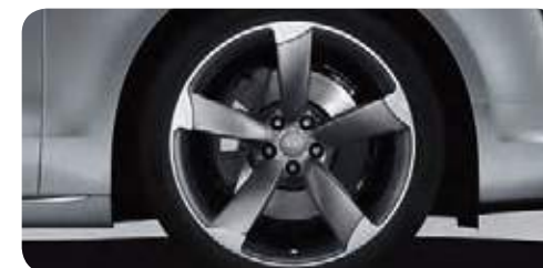
アルミホイール 5アームローターデザイン マットチタンルック ポリッシュ 9]×21 (Audi Sport) [Audi A8、A8 L、A8 L W12にオプション]
