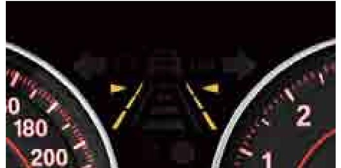
ドライビング・アシスト(レーン・ディパーチャー・ウォーニング(車線逸脱警告システム)、前車接近警告機能)\*: レーン・ディパーチャー・ウォーニング(車線逸脱警告システム)は、60km/h以上での走行時に、フロント・ウインダーに設置されたカメラで前方の車線表示をモニターします。車線からクルマが不意に逸脱しそうになると、直ちにステアリング・ホイールを軽く振動させ、ドライバーに知らせます。ただし、ターン・インジケータを作動させた際には、この警告は発せられません。また、前車接近警告機能は、前方車両に近づき過ぎたり、衝突の危険を察知した場合に、2段階の警告を発します。
