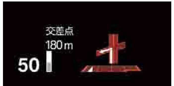
**BMWヘッドアップ・ディスプレイ\***: ドライバーが常に前方の道路状況に集中できるよう装備された、BMWヘッドアップ・ディスプレイ。現在の车速、ナビゲーション・システムによるルート案内の矢印表示、チェック・コントロール、レーン・ディパーチャー・ウォーニング(車線逸脱警告システム)\*の作動状況、曲名やラジオ局のリストなど、さまざまな情報をフロント・ウインダーに投影することで、ドライバーの视界内に直接表示します。
