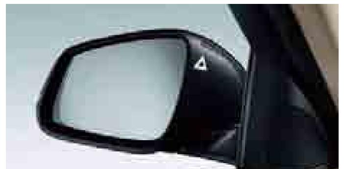
レーン・チェンジ・ウォーニング\*: 50km/h以上で走行中にリヤ・バンパーに組み込まれたセンサーが左右後方の車両や追い越し車線上を急接近てくる車両を認識し、ドア・ミラー内側に組み込まれたインジケーターを点灯させ、ドライバーに警告します。
