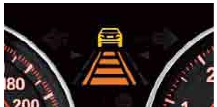
**ACC／アクティブ・クルーズ・コントロール(ストップ&ゴー機能付)、前車接近警告機能(衝突被害軽減ブレーキ付)\***: 停車／発進をくり返す渋滞時の運転負荷を軽減し、アクティブ・セーフティに貢献。先行車との車間距離を維持しながら加減速を行うアクティブ・クルーズ・コントロールに、低速走行時に車両停止まで制御する機能を装備。前方の渋滞が緩和すると、システムが任意に設定した速度まで加速させます。また、前車接近警告機能は、アクティブ・クルーズ・コントロールを作動させていない場合でも、前方車両に近づき過ぎた場合に2段階で警告を発し、ドライバーの注意を促すとともに、衝突の危険がある場合には軽度のブレーキをかけ、衝突の被害を軽減させます。
