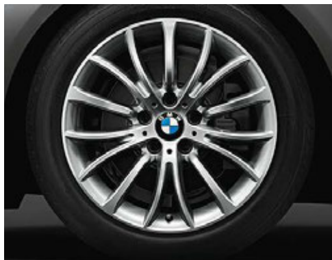
* 18インチ マルチスポーク・スタイリング454 アロイ・ホイール : 8J×18ホイール、 245/45R18タイヤ (ランフラット・タイヤ)
