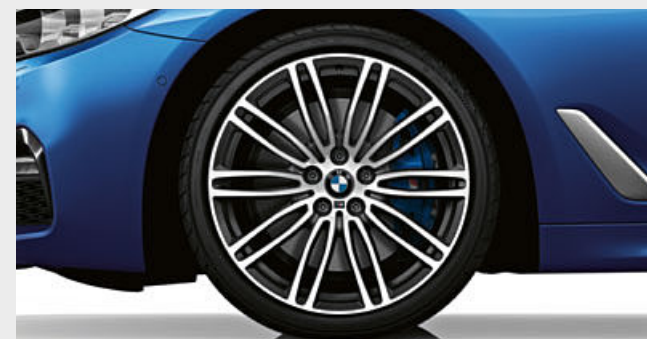
19インチ M ライト・アロイ・ホイール・ダブルスポーク・スタイリング664M*1:(フロント)8J×19ホイール、245/40R19タイヤ、(リヤ)9J×19ホイール、275/35R19タイヤ(ランフラット・タイヤ)
