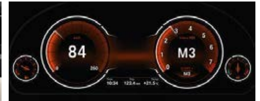
□ マルチ・ディスプレイ・メーター・パネル：文字を拡大表示したり、警告やメニュー表示を大きくすることにより、走行時の快適性や安全性を高めます。ドライビング・パフォーマンス・コントロールのボタンを操作すると、メーター・パネルの表示が走行モードに応じて変化し、色の違いでドライビングの雰囲気も演出。また、スポーツ・モードを選択すると、現在の速度と回転数が表示されます。
