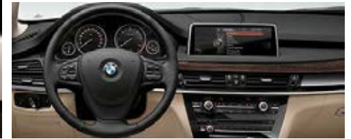
* マルチファンクション・レザー・ステアリング・ホイール：3本スポークのレザー・ステアリング・ホイールです。アクティブ・クルーズ・コントロールやハンズフリー・テレフォン・システム、オーディオ・コントロールなどの操作系統を配置。ドライバーは運転に集中できるため、安全性が向上します。(写真は日本仕様とは一部異なります。)
