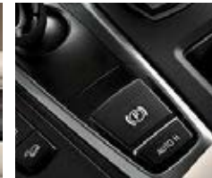
■ ボタン式パーキング・ブレーキ / オートマチック・ホールド・ボタン：センター・コンソールに配されたボタンによって、パーキング・ブレーキのロックと解除がワンタッチで行えます。また、オートマチック・ホールド・ボタンを押すと、信号や渋滞で車両が停止した場合にパーキング・ブレーキが自動的に作動します。アクセルを踏むとパーキング・ブレーキは解除されます。
