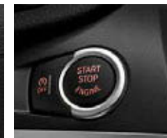
■ スタート/ストップ・ボタン：リモート・コントロール・キーを持って乗車し、スタート/ストップ・ボタンを押すだけで、エンジンの始動/停止を行うことができます。
