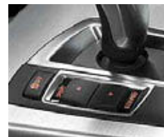
■ ドライビング・パフォーマンス・コントロール(ECO PROモード付)：ドライビングのスタイルに合わせ、走行特性を最適化。コンフォート、「スポーツ」、「ECO PRO」の3段階の設定から選択が可能です。xDrive35i、およびダイナミック・ダンピング・コントロールの場合は「スポーツ・プラス」モードが追加されます。 ※写真は日本仕様とは一部異なります。
